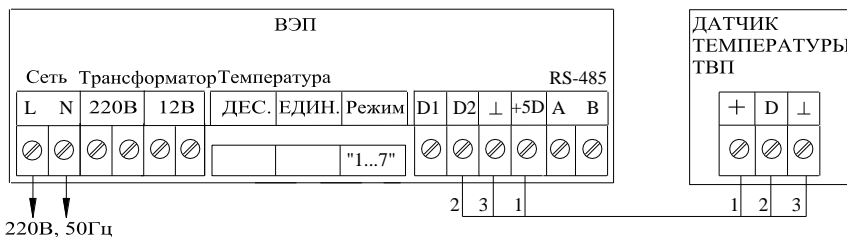
Рисунок А.5 Схема подключения ЭИМ ВЭП-12Х при работе в режиме «0».
