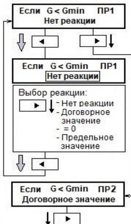
Рисунок Н.17 - Мнемосхема изменения параметра «НС G < Gmin ПР»
