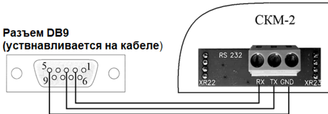
Рисунок В.5 – Схема подключения счетчика к компьютеру
